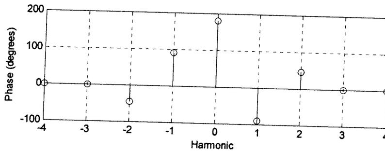
$$C_k^y = C_k^x H(jk\omega_0) \quad \text{or} \quad C_k^x = \frac{C_k^y}{H(jk\omega_0)} = \frac{|C_k^y| \angle C_k^y}{|H(jk\omega_0)| \angle H(jk\omega_0)}$$
